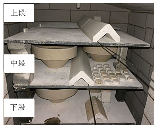
図3 0.1m 3 ガス焼成炉内の様子
