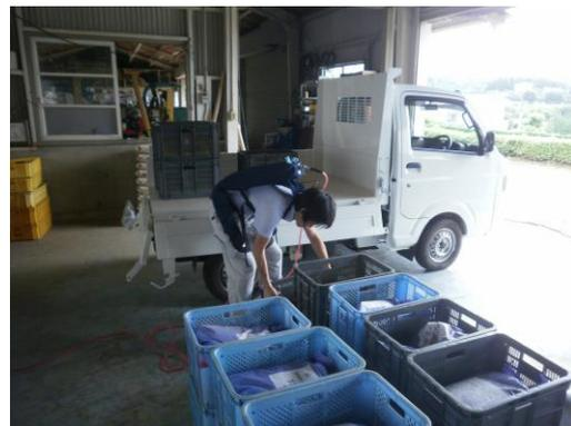
写真1 アシストスーツ使用による運搬試験状況（左：リベロ、右マッスルスーツ）
