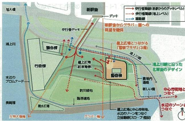
図 2.2 配置計画、動線計画の考え方
