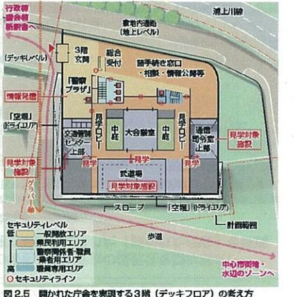
図 2.5 開かれた庁舎を実現する3階(デッキフロア)の考え方
