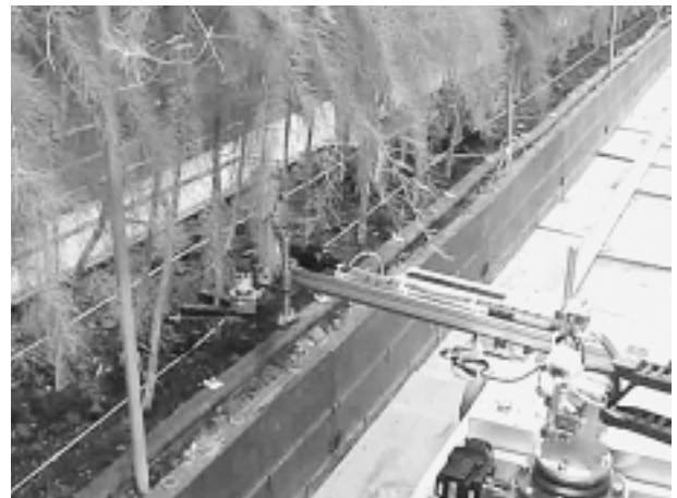
Fig .16 アスパラガス収穫実験（収穫中）
