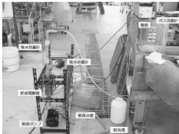
図1 新規電解槽の実験システム
