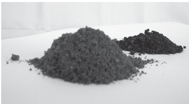
図2部分的に液化した木材の性状 (Phenol/Wood=1/1, Temp.=175°C(左前), 225°C(右奥))
