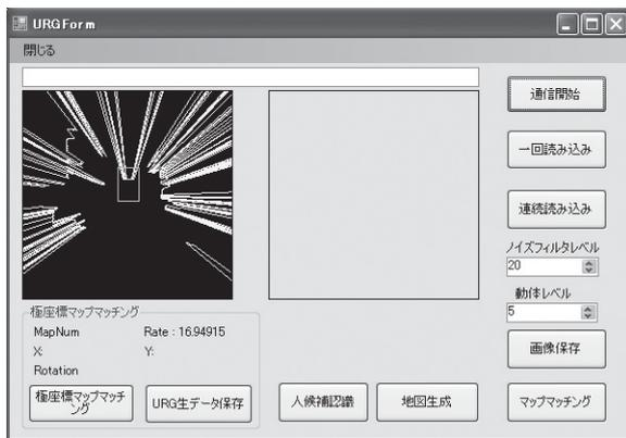
図6 レーザーレンジファインダセンサ管理画面
