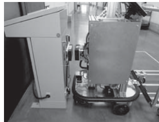
図3 充電ステーション 図4 非接触充電の様子
