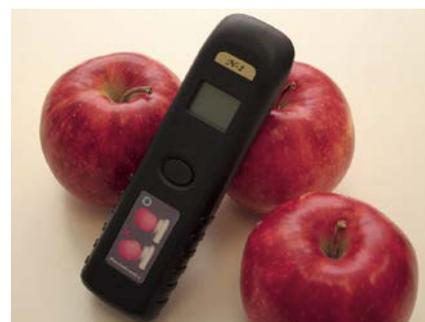
図1 TFDRS法を用いて商品化した携帯型糖度計。光源に発光ダイオードを使用して重量200gと世界最軽量を実現した。
