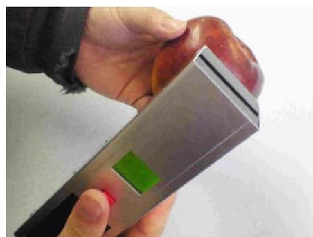
図3 試作した測定装置の外観。光源に半導体レーザを搭載し、重量約300gのリモコン並の装置を実現した。
