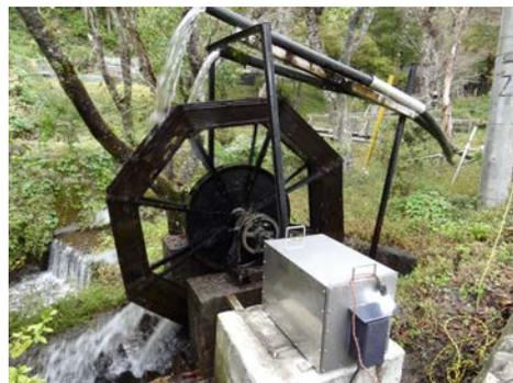
図1 200W 対応発電システム
