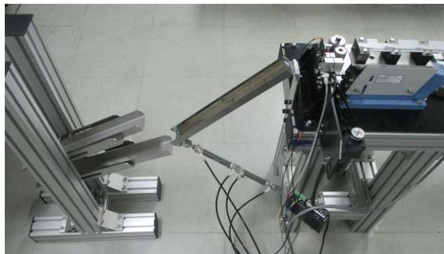
図2 試作した自動測定システム
