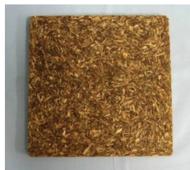
図2 試作した木質ボード
