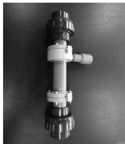
図3 試作した新規電解槽の外観
