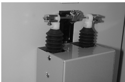
図5 スライドロボット機構(取り付け時)
