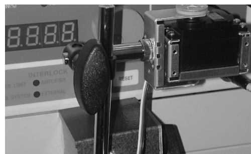
図7 押しボタンロボット機構(取り付け時)
