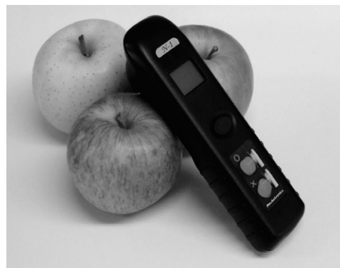
図2 TFDRS法をベースに商品化した携帯型糖度計。光源に発光ダイオードを使用し、重量200gと世界最軽量を実現した。
