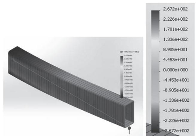
図4 形状変更前の角パイプ (□50×100×3.2-600) の応力分布
