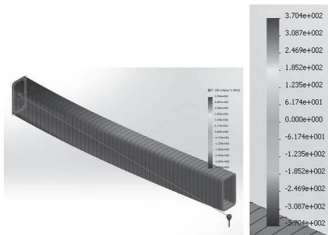
図5 最低化ソフトウェアが提案する角パイプ (□40×80×4.0-600) の応力分布
