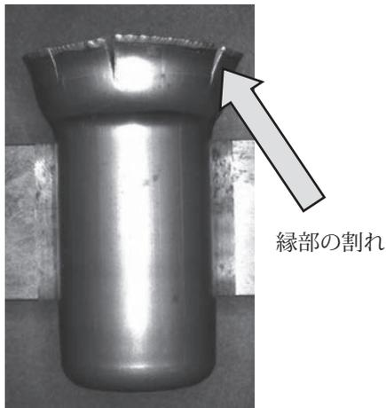
図3 3工程での縁部の割れ
