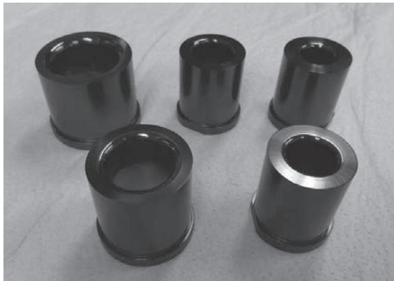
図7 DLC膜をコーティングしたプレス金型
