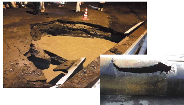
写真：平成27年11月に長崎県内で発生した漏水事故の現場と破損した水道管
