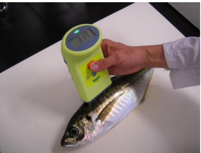
試作機によるマアジの測定状況
