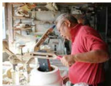
回転する台に石膏製の型をセットし、こてで坯土を押しながら形づくる「機械ろくろ成形」。皿やボウルなどを同じ形状で大量に製作する場合に用いられることが多い。
