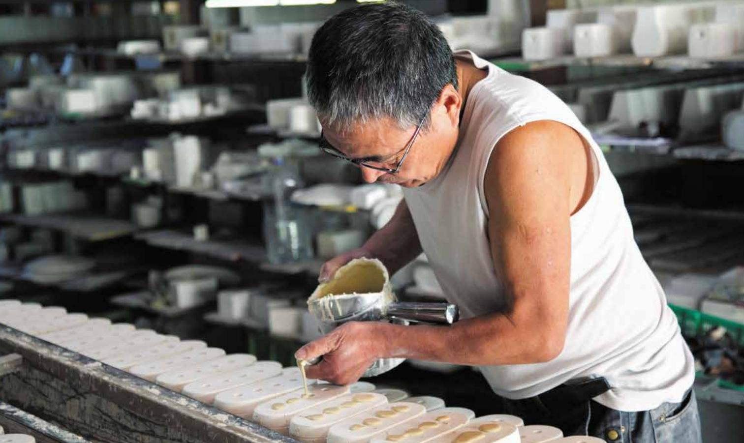
石膏製の型に泥漿(液状にした坯土)を流し込んで形づくる「排泥鑄込み成形」。急須や土瓶などの袋もの製作に適している。
