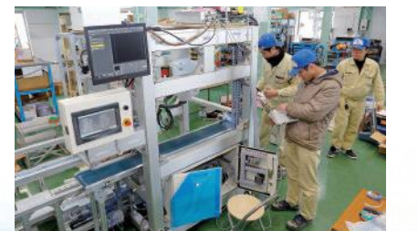
箱詰めするロボットシステムの動作の確認作業
