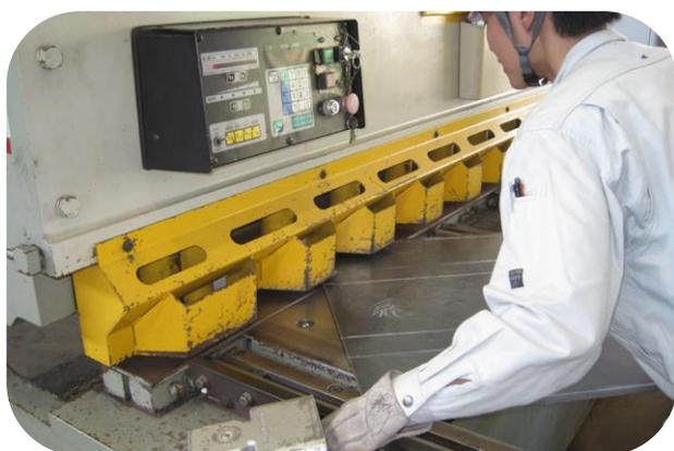
動力シャーによる切断作業
