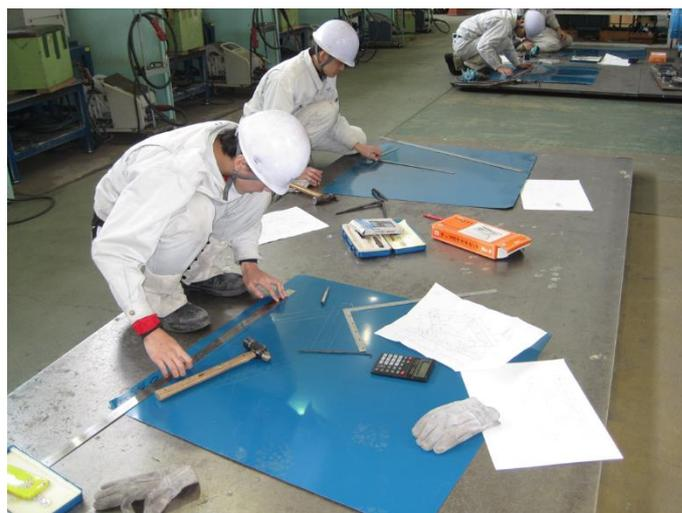
製図（原図作業）
