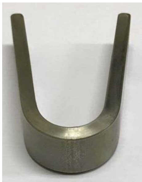
試験後の曲げ試験片
