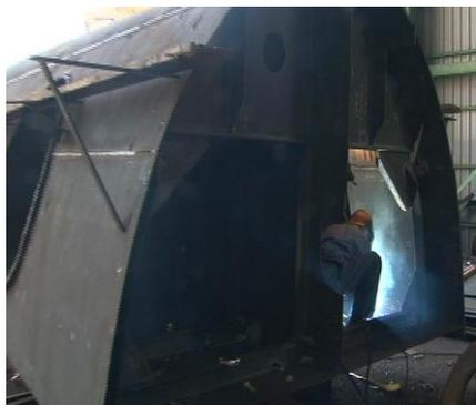
そして、1つ1つの鉄板を「溶接」という技術で接合していくと、図のようなブロックが出来ます。同じように船首、中間部、船尾部等も製作します。
