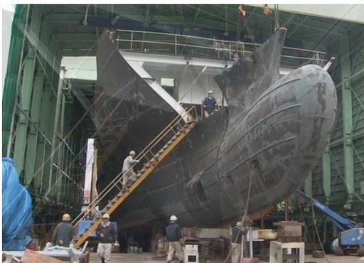
1つ1つのブロックを図のようにクレーンで吊って組み立てます。
