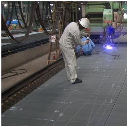
鉄板を図面通りに切断しています。
