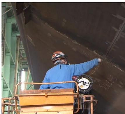
溶接して接合したところを検査します。検査して、欠陥が見つかったら、欠陥を取り除き、再度溶接を行います。皆さんの命を守る為に、「溶接」の技術が大事です！！
