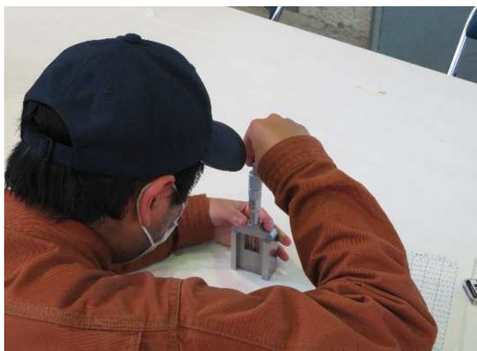
精密測定器を使って、0.01 mm単位の測定ができるようになります。
