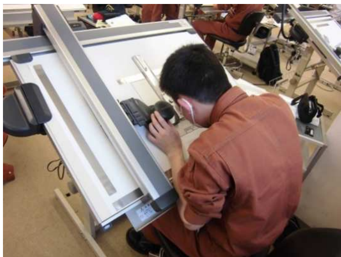
製図機を使って、機械部品の図面の作成を学びます。
