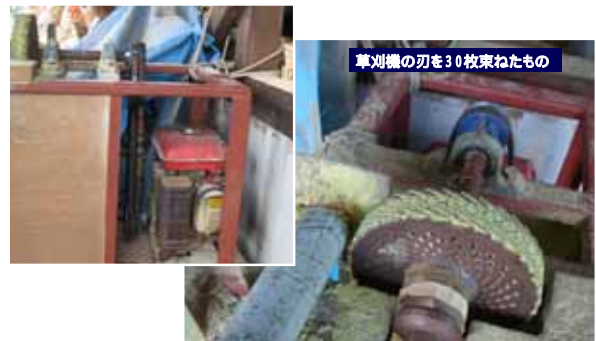
写真 - 1 竹粉碎機の構造
