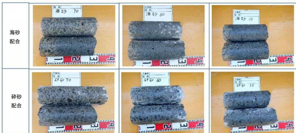
写真-5.1 充填状況確認（経時変化別）
