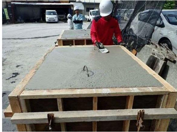
写真-5.2 大型ブロック供試体の仕上げ状況
