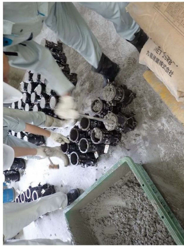
圧縮強度試験用供試体作成状況
