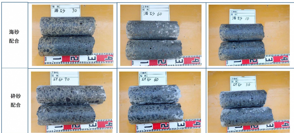
写真-5.6 充填状況確認 (経時変化別)
