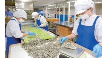
貝殻や海藻などの異物は人の手で念入りに除去された上で出荷される
