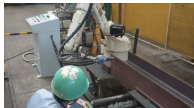
自動鋼材切断ロボットの開発テスト
