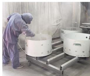
検査で合格した製品は後処理で塗装や、表面の油などをふき取り、梱包して完成となります。
