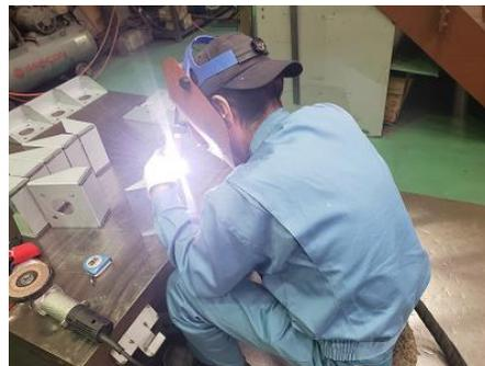
折り曲げた物や、その他の金属部品を溶接して組み合わせていき、一つの製品にしていきます。
