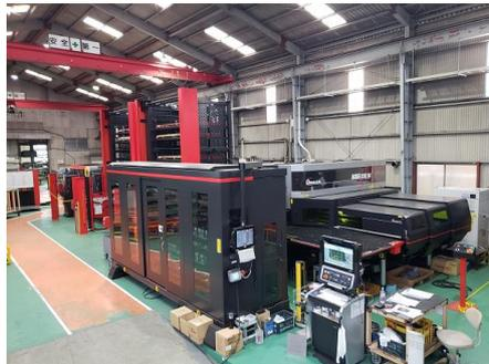
金属の板を切断する機械です。材料をセットしてプログラムを読み込むだけで自動で動きます。レーザー光線での切断や金型を用いて加工を行い、色んな形状に切断していきます。
