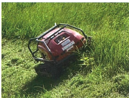
傾斜地におけるラジコン草刈機
