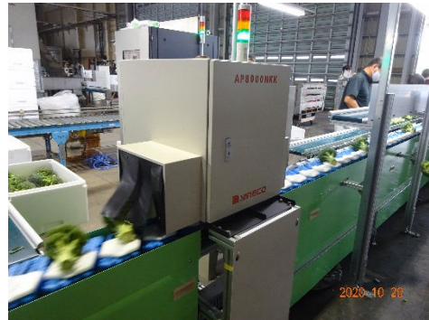
光センサー及びAI自動判別システムによる ブロッコリーの選果
