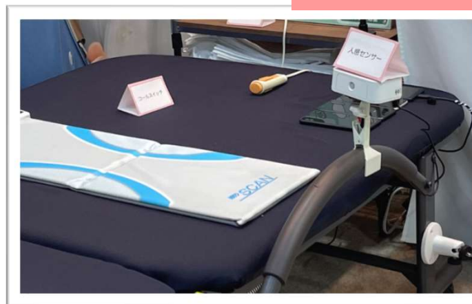
電源コード付き 人感センサー／起上り検知
