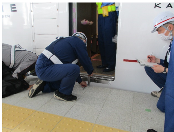
車両とホームの離隔幅を確認する様子
