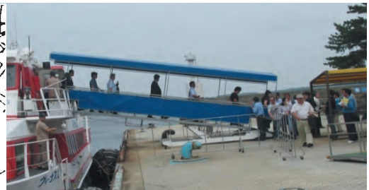
干満により2階からの乗下船となる。 (博多港は1階からの乗下船)
