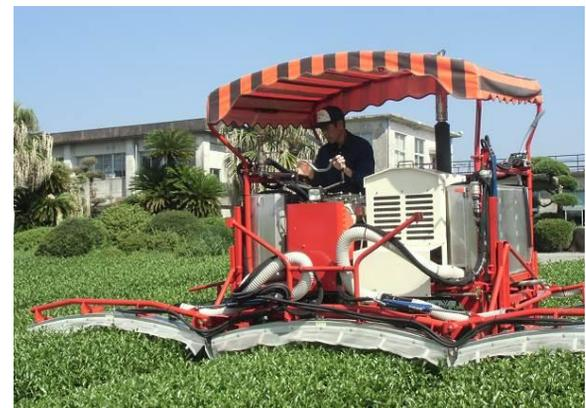
写真5 乗用少量農薬散布機
