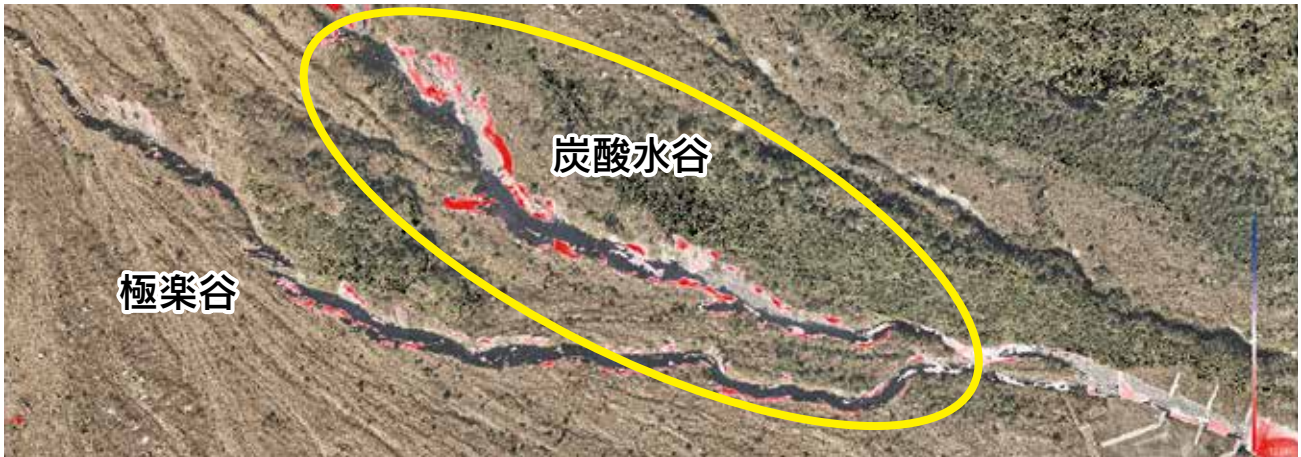
図1 雲仙普賢岳レーザデータ (R3. 11) ※赤色表示はH28とR3の比較による崩壊箇所 ※ガリー (gully) とは、降水による集約した水の流れによって地表面が削られてできた地形のこと。
