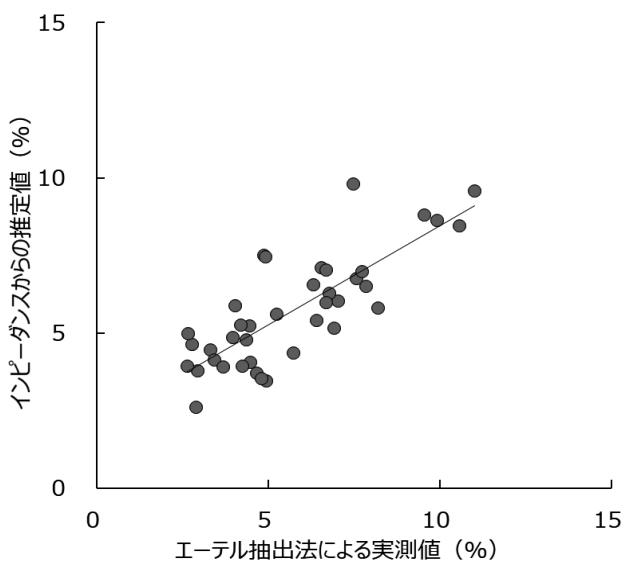
図1 シイラ粗脂肪量の実測値と魚用品質状態判別装置による推定値との関係
