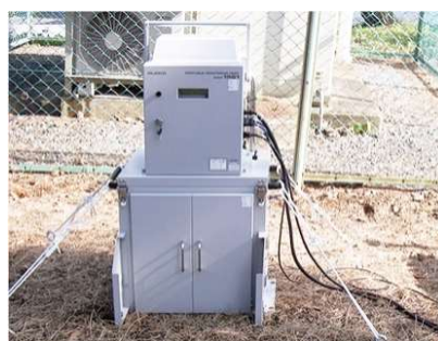
可搬型モニタリングポスト (衛星系回線による通信機能付)
