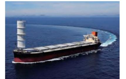
伸縮する鋼鉄製の帆を搭載した環境対応船
