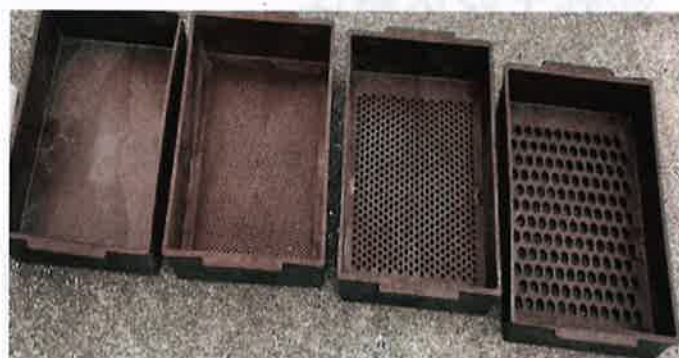
パーティクルセパレーター 各箱の穴の大きさが違い、粗飼料を入れてふるうことで、粗飼料の細断長の割合がわかる
