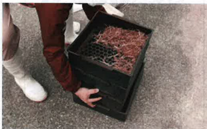
パーティクルセパレーター 各箱の穴の大きさが違い、粗飼料を入れてふるうことで、粗飼料の細断長の割合がわかる
