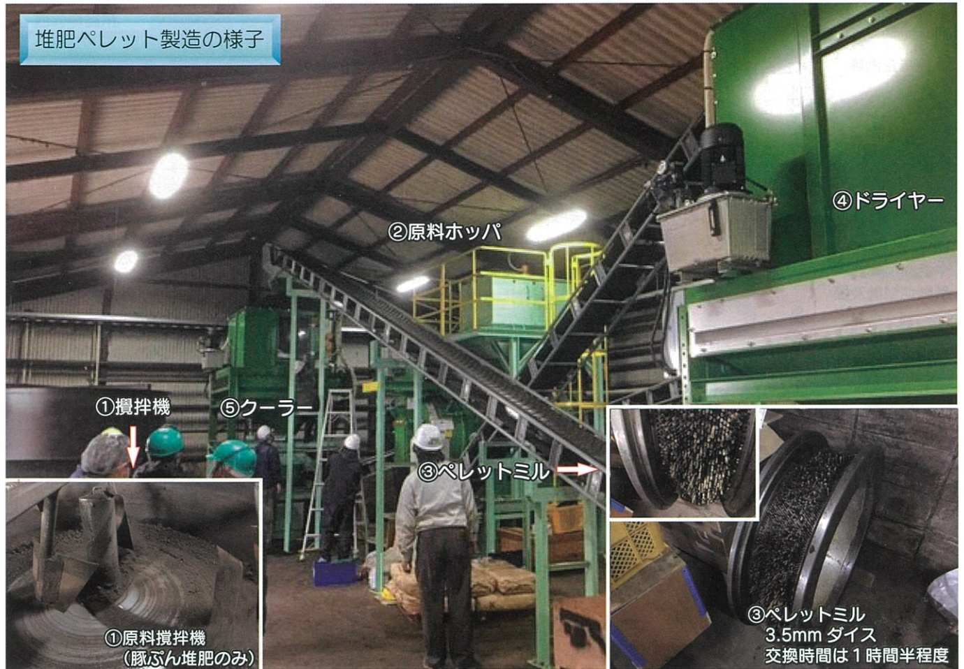
※地域資源を活用した堆肥ペレットの製造工程（詳細は、8ページ参照）
