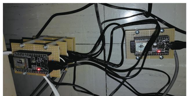
図 2 電流計測用マイコンボード
