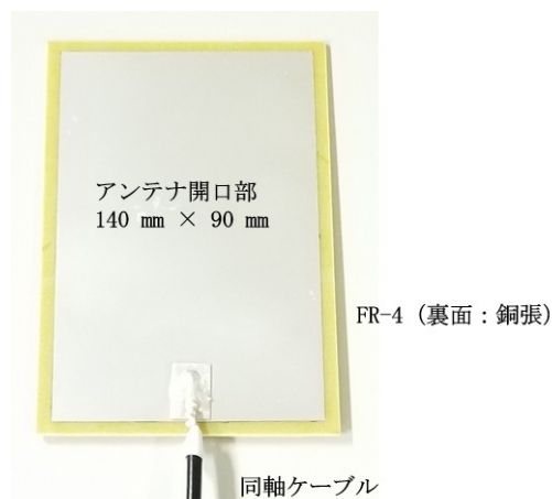
図2 試作した平面アンテナ
