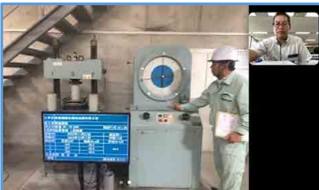
【圧縮強度試験 立会状況（工場側）】
