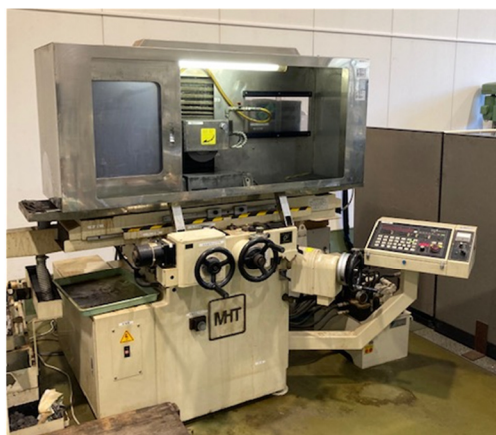
平面研削盤による加工実験
