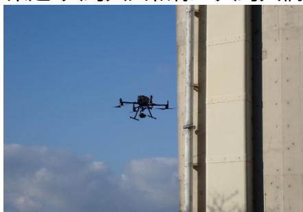
〈定期点検—無人航空機〉
