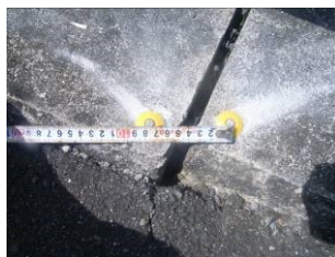
定点観測例(金属標設置例の例)
