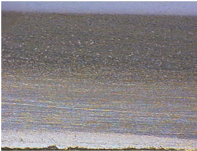
図7 Mo/Mullの光学顕微鏡写真
