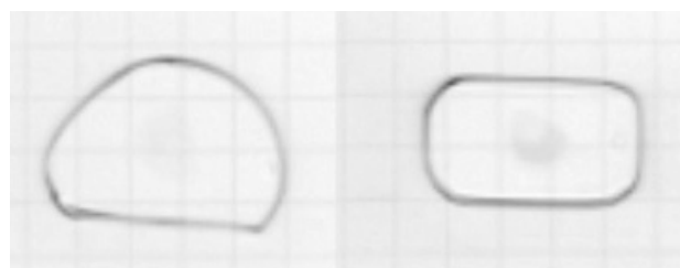
図3 レーザー照射後の試料写真 左：50CaO-50P 2 O 5 、右：フッリン酸塩ガラス
