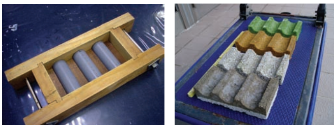
図2 塩ビパイプを配置した木型及び各原料を用いた基質
